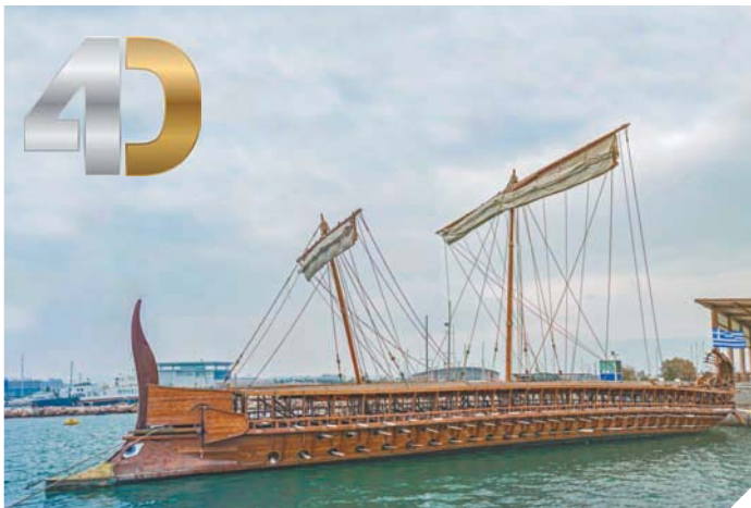
Современная реплика греческой триеры — боевого корабля, оснащенного тремя рядами весел. Паруса на ней ставили только при попутном ветре. Такие суда использовали также финикийцы и римляне.
