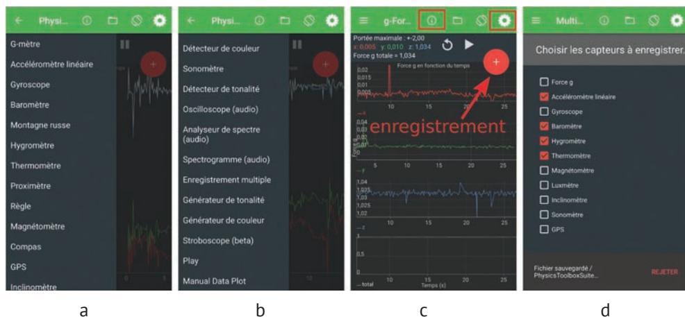
Рис. 2.3. а), б) Различные возможности и датчики приложения Physics Toolbox Suite , в) запись данных на примере акселерометра, г) пример одновременной записи данных с нескольких датчиков
