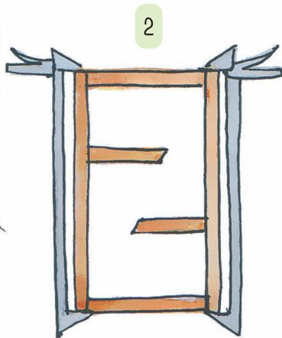
3. Приклей и закрепи шурупами полки, обрежь их под углом.
