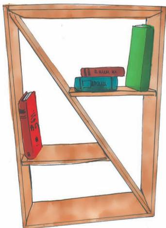
4. Вставь диагональную деталь, приклеив ее к полкам и к боковым деталям этажерки. Чтобы облегчить задачу установки диагональной детали, отшлифуй края полок. Готовое изделие можно покрасить или покрыть лаком.
