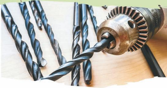
11. Ручная дрель — механический инструмент для сверления отверстий в различных материалах. Хотя сейчас в основном используются электрические дрели, для работы в труднодоступных местах и для тонких работ по-прежнему в ходу ручные дрели.
