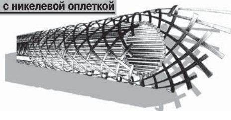
Рис. 3. Структура удилища из углепластика с никелевой оплеткой
