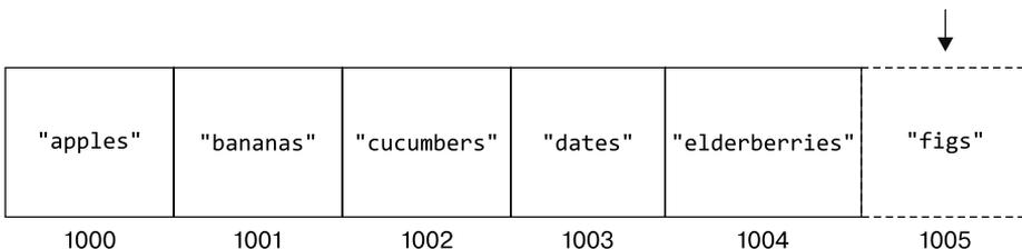
Но есть одна проблема. Поскольку изначально компьютер выделил под массив только пять ячеек памяти, при добавлении шестого элемента ему придется найти дополнительные ячейки. Как правило, это делается автоматически, но каждый язык программирования обрабатывает этот процесс по-своему, поэтому я не буду вдаваться в детали.
