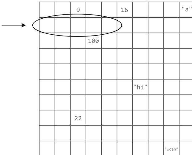
У каждой ячейки есть определенный адрес. От почтового, где содержатся названия улиц и городов, его отличает лишь то, что он представлен числом. Значение адреса каждой последующей ячейки памяти на одну единицу превышает значение предыдущей:
