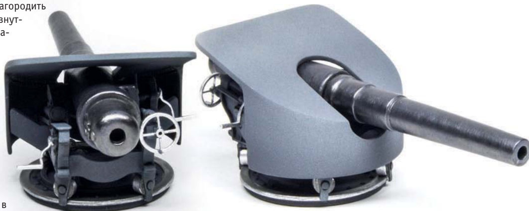
Слева: Подборки: щит, лафет, станок, люлька, орудие. Справа: Изнутри на уголке скрепления вертикальных стенок и крыши щитового прикрытия симитировал головки заклепок, но на собранной модели их не будет видно.
