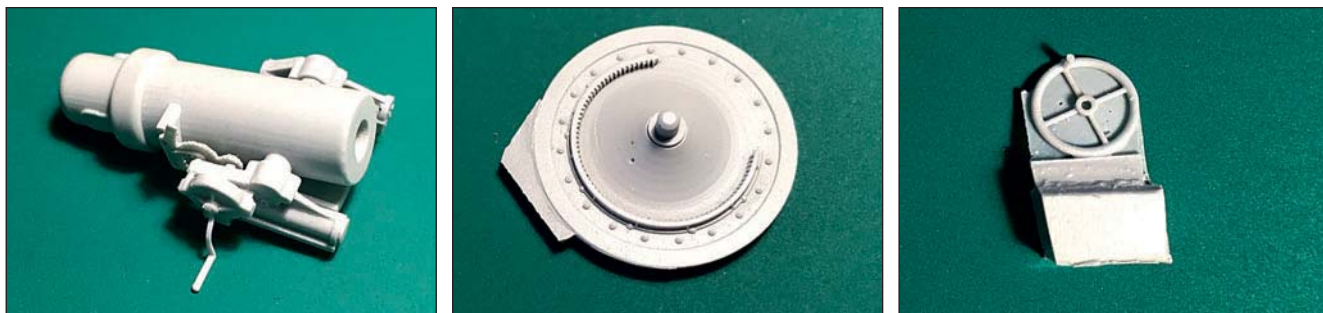
Слева и в центре: На смоляных деталях есть едва заметные «ступеньки», оставшиеся от слоев выращивания мастер-модели на 3D-принтере. Справа: Маховик системы наведения в облое. Сделано так специально для сохранения геометрии детали, удаляется облой легко.
