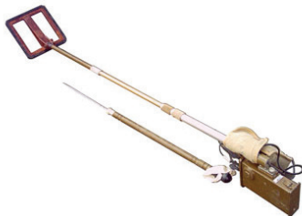
Рис. 1.3. Переносной индукционный миноискатель ИМП-2
