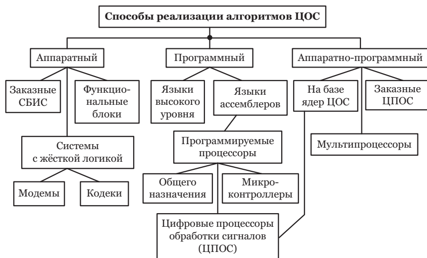
Рис. 1.3. Способы реализации алгоритмов и систем ЦОС
