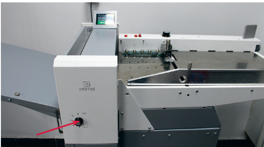
Рукоятка (показана на фото) регулирует силу удара биговального ножа
