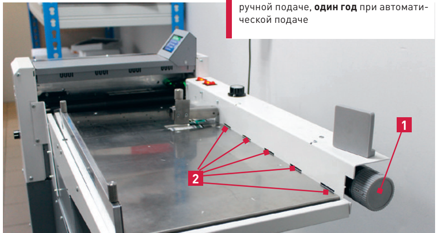
Круглая ручка (1) регулирует раздув из щелей (2). Благодаря раздуву подача листов осуществляется более стабильно
