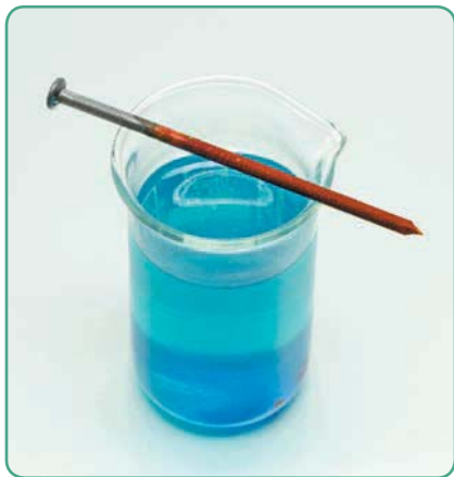
Рис. 4. В растворе сульфата меди(II) железный гвоздь покрывается слоем меди
