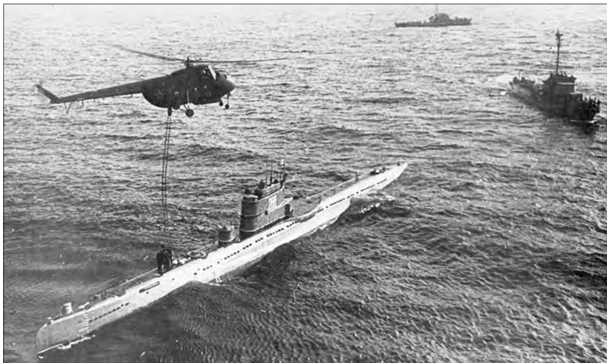
Подводная лодка С-43 проекта 613С в море; перед ограждением рубки – КСУ
