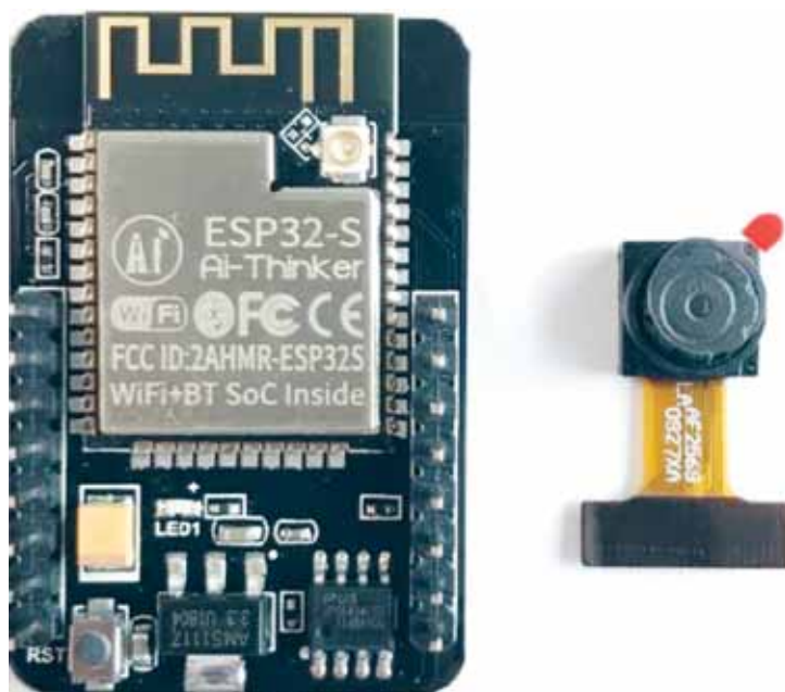
Рис. 1.6. Модуль ESP32 AI-Thinker с видекамерой
