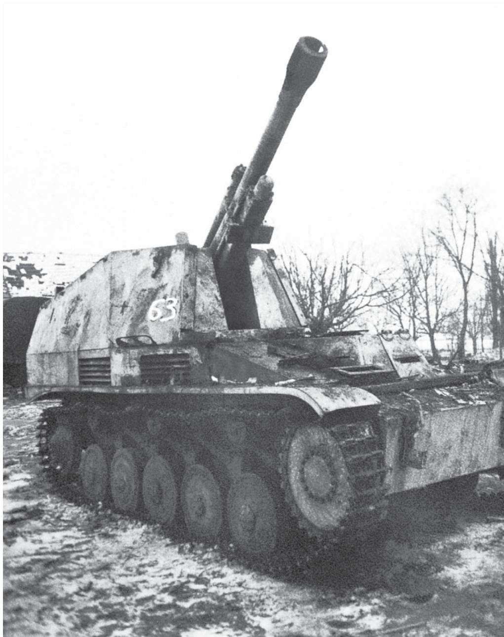
105-мм легкая самоходная гаубица «Wespe», брошенная экипажем на окраине Будапешта. Февраль 1945 года. Самоходка имеет зимний камуфляж, обозначения (кроме номера 63 советской трофейной команды) отсутствуют. Предположительно машина принадлежала 13-му артиллерийскому полку 13-й танковой дивизии (АСКМ).
