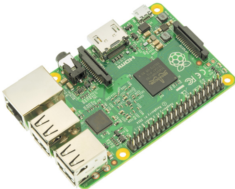
Рис. 1.2. Одноплатный компьютер Raspberry Pi 2 Model B
