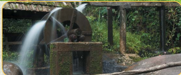
Водяное колесо с верхней подачей воды.
