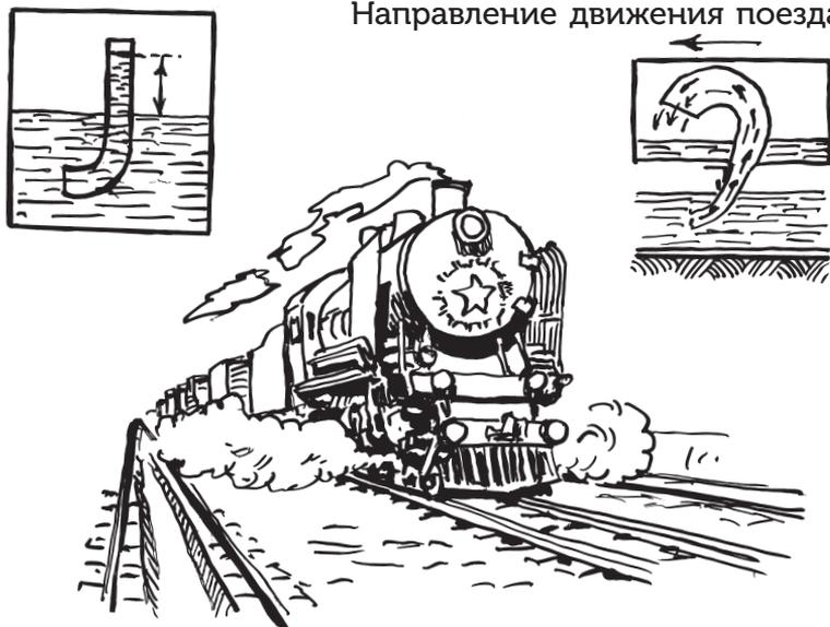
Рис. 4. Как паровозы на полном ходу набирают воду. Между рельсами устроен длинный водоем, в который погружается из тендера труба. Вверху налево — трубка Пито. При погружении ее в текущую воду уровень в трубе поднимается выше, чем в водоеме. Вверху направо — применение трубки Пито для набора воды в тендер движущегося поезда.
