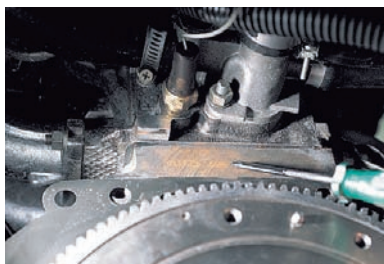
Номер двигателя выбит на блоке цилиндров над маховиком (для наглядности коробка передач снята).
