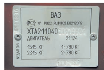
Данные об автомобиле приведены в табличке, закрепленной на правой чашке опоры телескопической стойки.
