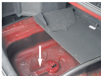
...и на усилителе пола багажного отсека (номер показан стрелкой, запасное колесо извлечено).
