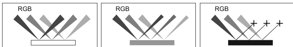
Рис. 1.4. Механизмы отражения красного, зеленого и синего компонентов света ахроматическими поверхностями: белой, серой и черной (слева направо)
