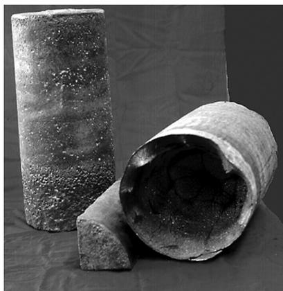
Рис. 2.2. Кальций металлический (дистиллированный – справа; слиток – слева)
