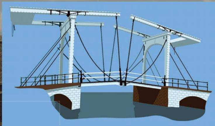
Стальной аналог двухстворчатого моста с ручным механизмом подъема и опускания.
