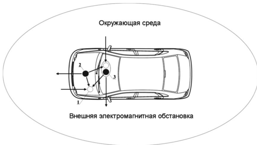
Рис. 1.1. Структура взаимодействия электрооборудования автотранспортного средства: 1 – рецептор; 2 – источник электромагнитных помех; 3 – система, включающая рецептор и источник
