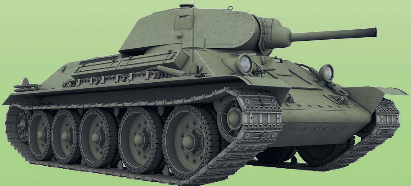
Серийный танк Т-34 выпуска 1940 года с 76-мм пушкой Л-11
