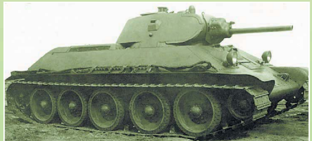
Серийный танк Т-34 выпуска 1940 года с 76-мм пушкой Л-11
